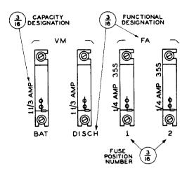
Fig. 23 - Alarm-Type Fuses
