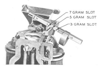
FIG. 6 — GAUGE FOR GROUND SPRING CONTACT PRESSURE
